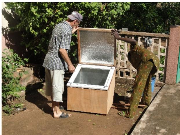
**1er essai du four solaire, dans la cour, derrière la cuisine de la communauté. Il ne reste plus qu'à l'orienter et à régler l'inclinaison du couvercle.**
